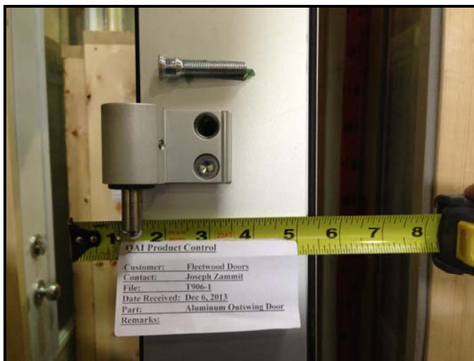
Fig. 20 – Slab hinge half
