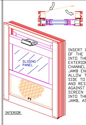
INSERT ONE SIDE OF THE SCREEN INTO THE EXTERIOR CHANNEL OF THE JAMB ENOUGH TO ALLOW THE OTHER SIDE TO SWING IN AND REST UP AGAINST THE SCREEN BLOCK INTO THE OTHER JAMB, AS SHOWN.
