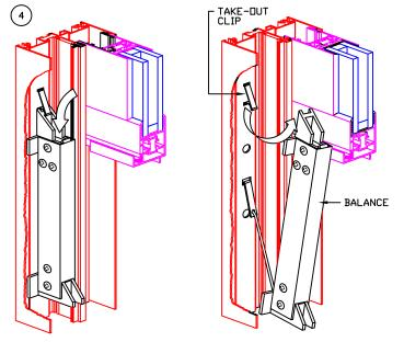
• DNCE SLIDING PANEL IS REMOVED, BALANCES MAY BE TAKEN DUT BY PUSHING THEM DOWN AND PULLING THEM DUT FROM UNDER TAKE-DUT CLIPS, AS SHOWN.
