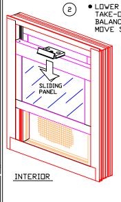
● LOWER THE SLIDING PANEL ABOVE TAKE-OUT CLIPS TO DISENGAGE THE BALANCE, THE PANEL IS NOW FREE TO MOVE SIDE TO SIDE WITHIN THE JAMBS.
