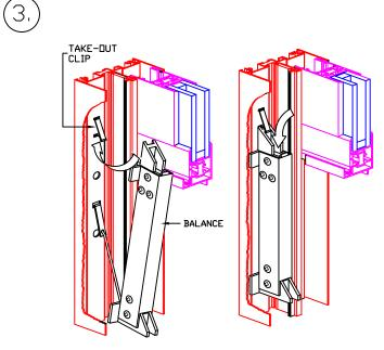
INSTALL THE TAKE-DUT CLIPS, AND LEAVE IN THE TAKE DUT POSITION.
