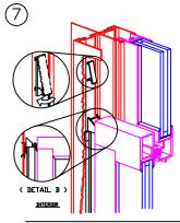
● LOWER THE SLIDING PANEL TO ENGAGE THE BALANCE AND CLEAR THE TAKE-OUT CLIPS. THE BALANCE WILL AUTOMATICALLY CENTER THE PANEL. SNAP THE TAKE-OUT CLIPS INTO THE OPERATING POSITION, AS SHOWN. (DETAIL B)
