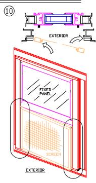
■ INSERT DNE SIDE OF THE SCREEN INTO THE EXTERIOR CHANNEL OF THE JAMB, RESTING IT WITHIN THE SCREEN BLOCKS AND COMPRESSING THE SPRING ENDUGH TO ALLOW THE OTHER SIDE TO SWING IN AND REST UP AGAINST THE SCREEN BLOCK IN THE OTHER JAMB, AS SHOWN
